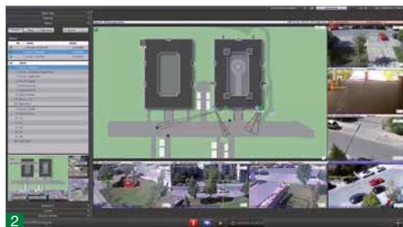
1 Zuverlässige Detektion von sicherheitsrelevanten Objekten oder Ereignissen mittels vordefinierbarer Zonen sowie Übermittlung von Event- und Metadaten an IPS VideoManager zwecks Anzeige, Aufzeichnung und Alarmbearbeitung.
