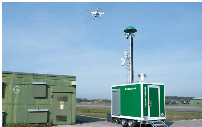
Abbildung: Verlegbares Drohnenabwehrsystem mit Hochleistungssensoren, -aktoren und eingebauter Einsatzzentrale
