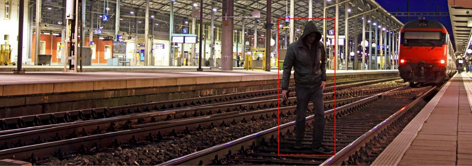
Abb. 1: Videodetektion mittels IPS VideoManager erkennt Personen, sendet eine sofortige Alarmmeldung und ermöglicht eine umgehende Intervention durch organisatorische Maßnahmen.
