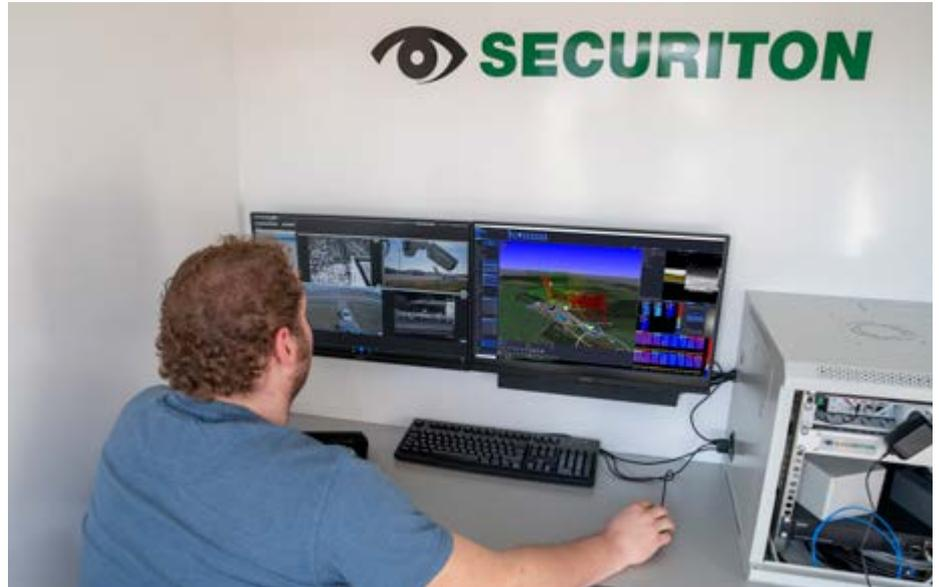
Im Alarmfall werden die richtigen Kameras gezeigt, welche bei Bedarf Person oder Drohne im betroffenen Gebiet verfolgen. Über intuitive Bedienungen im Lageplan lassen sich bewegliche Kameras ebenso manuell auf gewünschte Objekte steuern. Über unterschiedliche Avatare im Lageplan ist eine Verwechslung unmöglich. So lassen sich beispielsweise Flugobjekte einfach von anderen Objekten im System unterscheiden.
